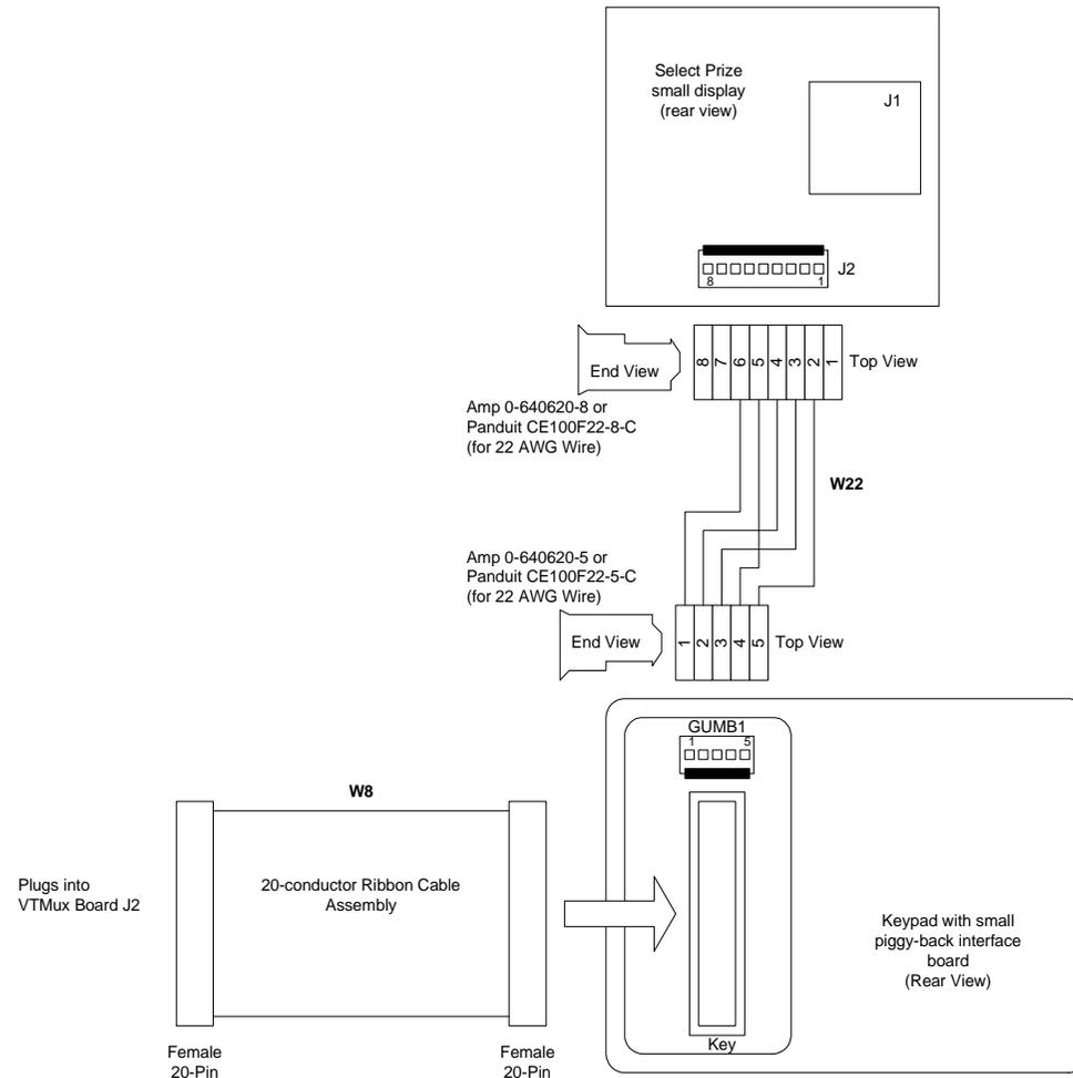
**FIGURE 29A – VTMUX BOARD J2 TO KEYPAD KEY**
