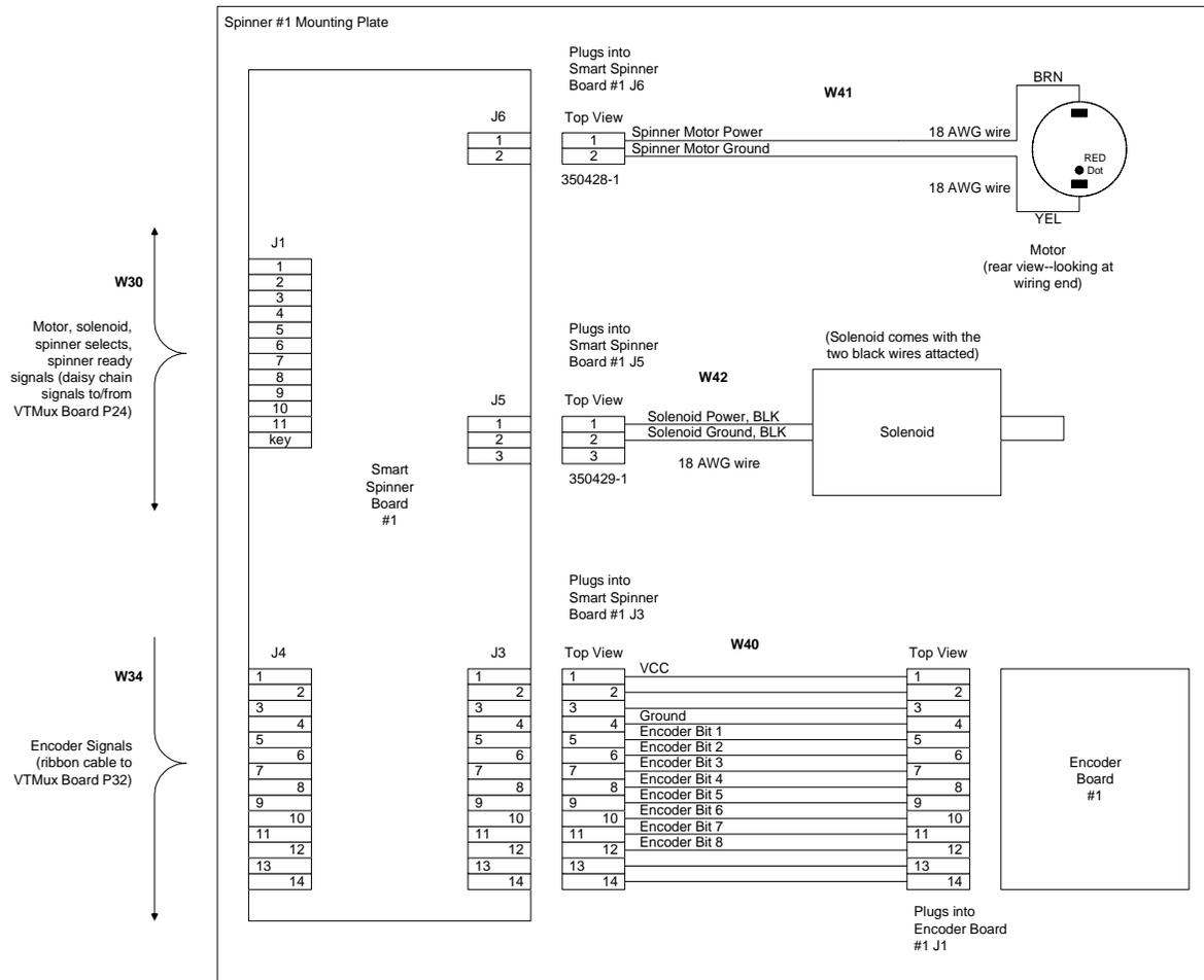
**FIGURE 8 SPINNER #1 SUBASSEMBLY**
