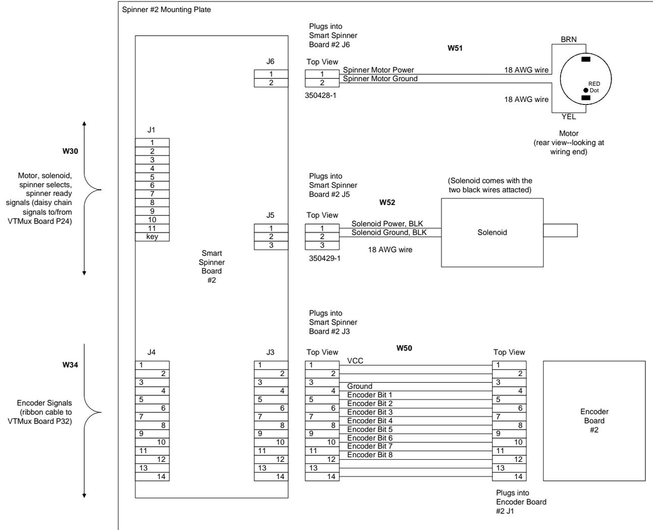
**FIGURE 9 SPINNER #2 SUBASSEMBLY**
