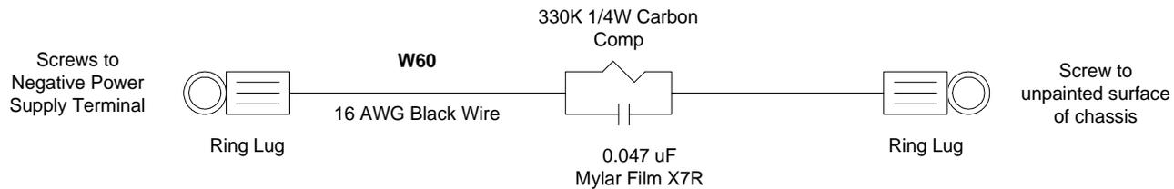
**FIGURE 26 CHASSIS GROUND**
