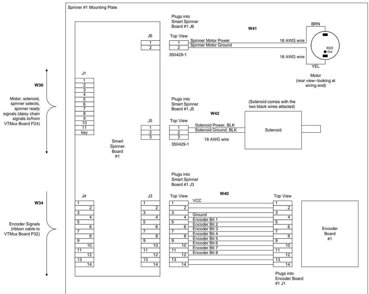
**FIGURE 8 SPINNER #1 SUBASSEMBLY**
