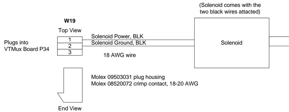
**FIGURE 16 VTMUX BOARD P34 TO BRAKE SOLENOID**
